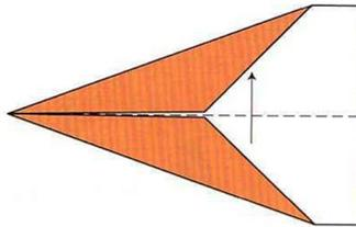
沿虚线将上层纸向前折叠形成机翼，距离b比距离a要稍长一些。下层纸也同样折叠。
